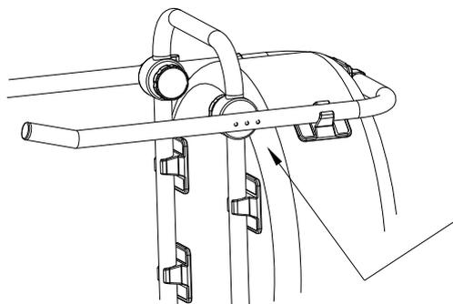
Hängen Sie den Träger über das Ersatzrad. Der Bügel geht dann hinter dem Rad und zwischen der Heckscheibe durch. Dieser Bügel hat unter den Kunststoffteilen drei Bohrungen die auf die Breite des Ersatzrades einstellbar sind. Hierzu muß der Rastverschluß entfernt werden. Entfernen Sie nur eine Seite und lassen Sie die andere Seite als Anschauungsobjekt erhalten.
