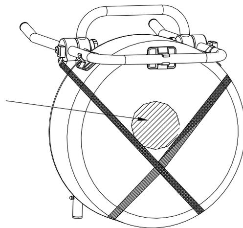
Die beiden Gurte mit Haken werden am Rahmen rechts und links der Heckklappe eingehängt und zwar so, dass der Träger nicht auf dem Ersatzrad kippen kann.
